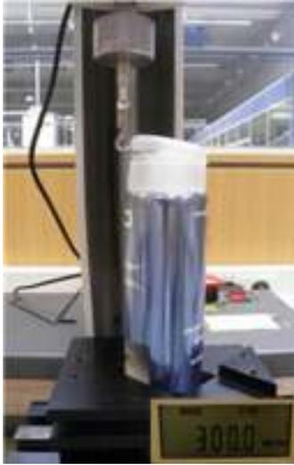
4. L'ouverture s'effectuera en tirant au niveau du milieu de l'onglet selon un axe parallèle à l'axe du mandrin-support et à une vitesse de 300 mm/min.
