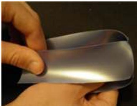
**2-** Plier le corps du tube jusqu'à la tête en rendant visible la partie intérieure dudit tube. Ensuite, exercer une traction manuelle entre le corps et la tête du tube avec le pouce comme si l'on essayait de séparer la soudure d'union visible entre le corps et la tête.
