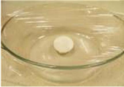
**4.** Couvrir le cristallisateur avec une couche de film protecteur (Parafilm). S'assurer que la surface est bien couverte pour éviter l'évaporation.
