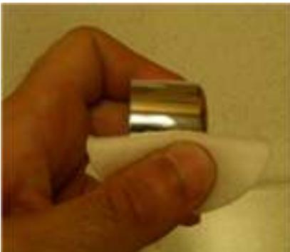
2- Ensuite, à l'aide d'un coton, frotter la surface décorée /traitée des échantillons soumis au test.
