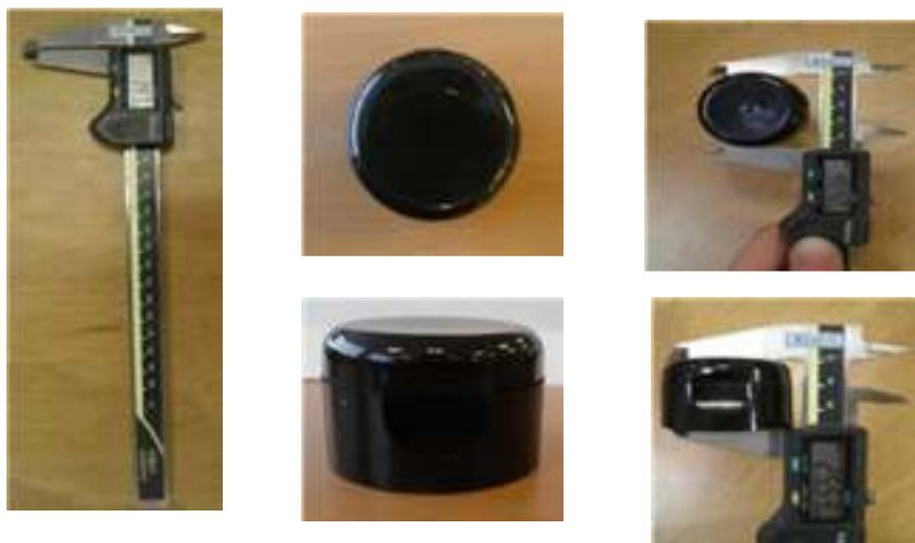
Afin de vérifier la conformité de la hauteur de fermeture de la capsule (AC):
