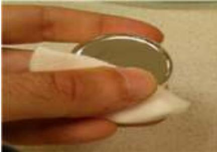
**5.** Retirer et réviser l'article après 4 heures: retirer le coton et frotter doucement la zone imprimée avec le doigt ou avec un chiffon doux.
