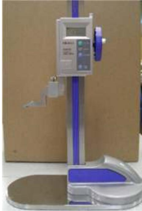
2. Mettre à "0" la lecture en appuyant la languette sur la superficie où sera déposé le tube à contrôler.
